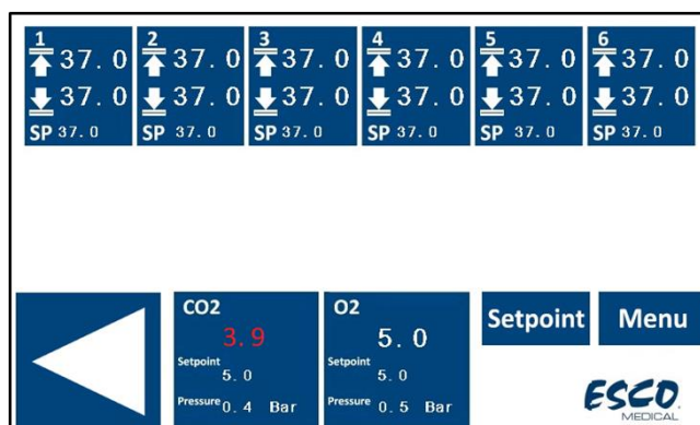
Slika 14.5 Prikaz alarma zbog niske koncentracije CO 2 na glavnom zaslonu višeprostornog IVF inkubatora MIRI® TL6
