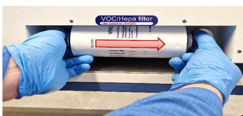
Slika 12.2 Postupak umetanja i uklonjanja VOC/HEPA filtra
