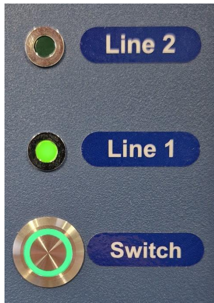
Slika 20.2 Prekidač za promjenu redaka višeprostrornog IVF inkubatora MIRI® TL12 i aktivni redak 1
