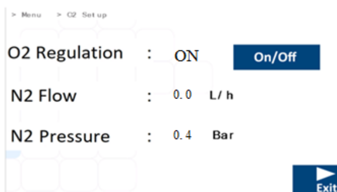
Slika 13.26 Prikaz podizbornika za postavljanje O 2 na višeprostorim IVF inkubatorima MIRI® TL6 i MIRI® TL12
