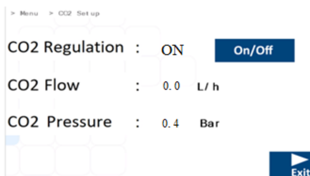
Slika 16.2 Prikaz podizbornika za postavljanje CO 2 na višeprostrornim IVF inkubatorima MIRI® TL6 i MIRI® TL12
