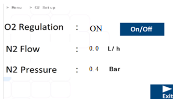
Slika 16.4 Prikaz podizbornika za postavljanje N 2 na višeprostrornim IVF inkubatorima MIRI® TL6 i MIRI® TL12
